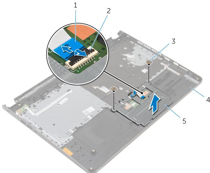
1 Kabel sledilne ploščice
